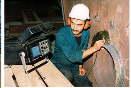
آزمایش التراسونیک Ultrasonic test
